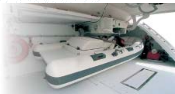
Telescopica con gru per movimentazione battello Telescopic model with crane for tender handling
